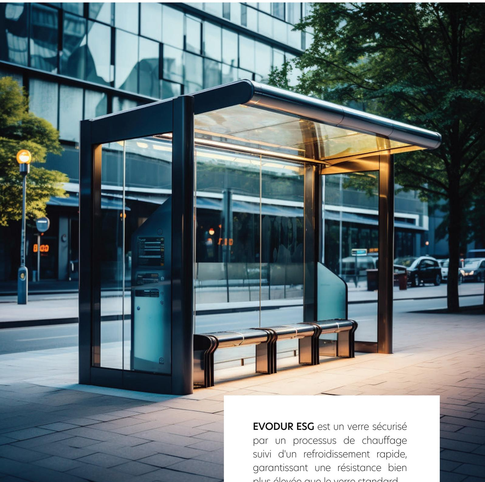
**EVODUR ESG** est un verre sécurisé par un processus de chauffage suivi d'un refroidissement rapide, garantissant une résistance bien plus élevée que le verre standard.
